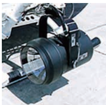
サーチライト装置
