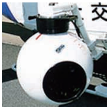
衛星通信設備映像撮影装置
